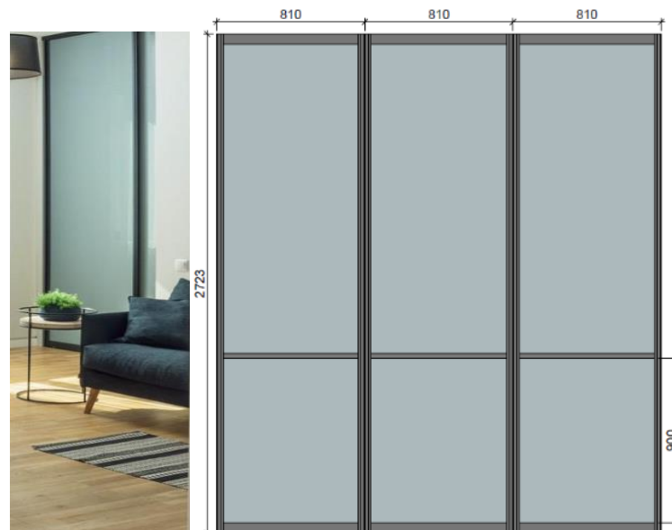
Guļamistabu skapji ar bīdāmām durvīm. Durvju profili melni (AMFLEX U10). Durvju pildījums – krāsots stikls (RAL 7042)
